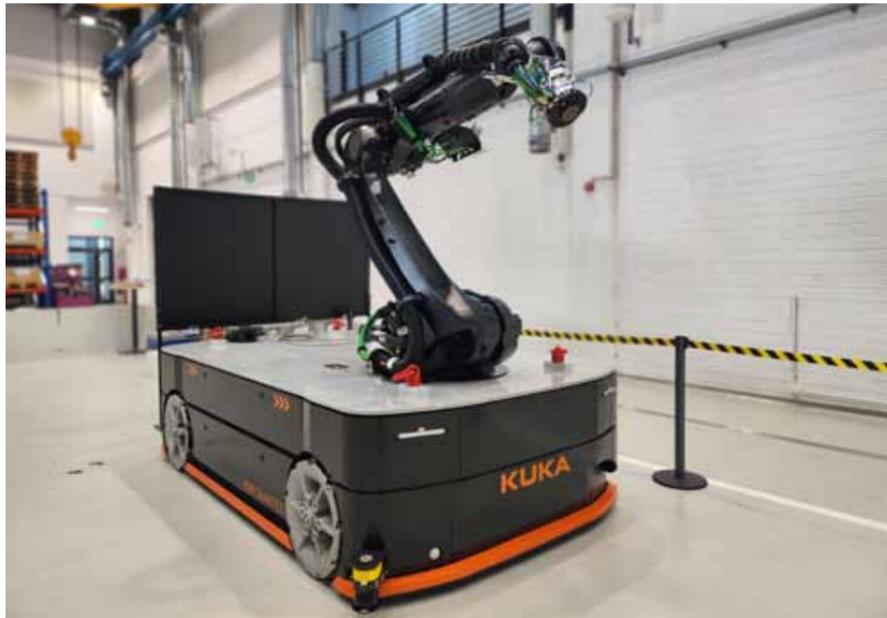
Der Großroboter KMR Quantec mit einer Nenn-Traglast von bis zu 270 kg hat seinen Platz in der WZL-Maschinenhalle gefunden
